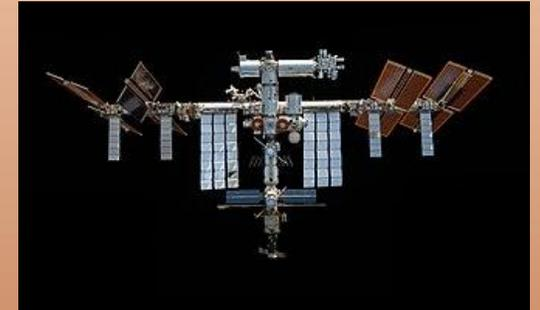
*Mastodonte de 400 tonnes, En orbite à 400 km. Dimensions 109 m x 73 m, 2500 m<sup>2</sup> de panneaux solaires réfléchissants. Magnitude qui culmine à -6*
