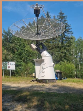
L'une de ces antennes parabolique de 5 m de diamètre, avec son système d'orientation vers le Soleil.
