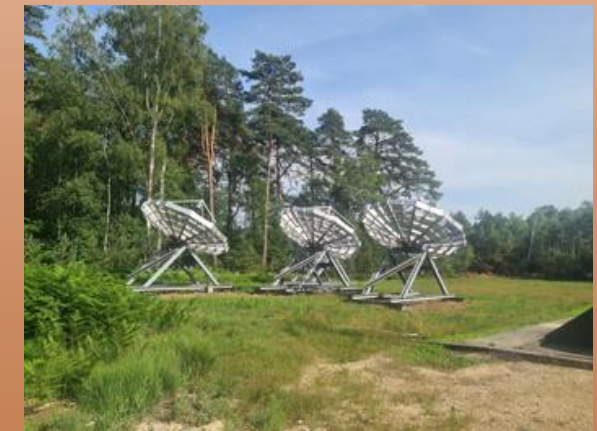
La quatrième antenne est cachée sur cette image. Les 4 antennes ne sont orientables qu'en hauteur. L'azimut est fixe, dirigé vers le sud.
